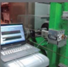
Inspección de defectos en cables metálicos de pequeño diámetro mediante la técnica de flujo magnético disperso
