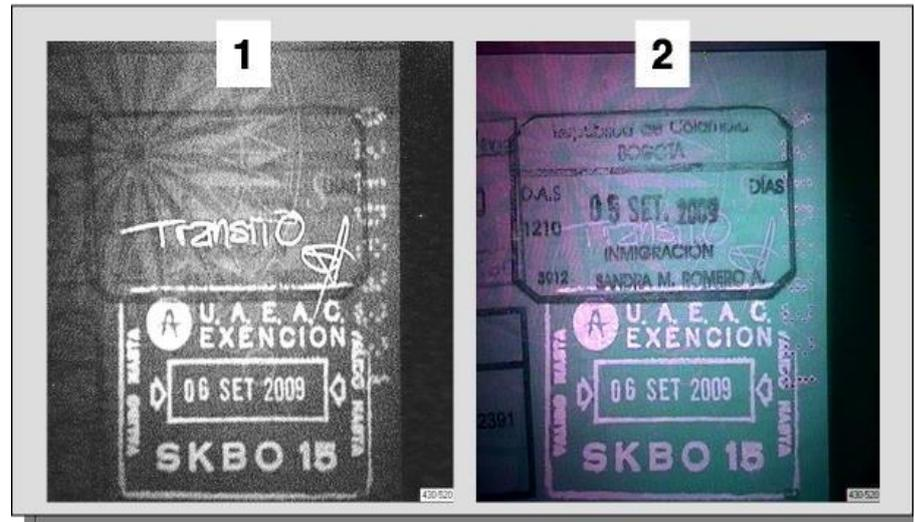
La **luminiscencia IR** no detecta la diferencia entre el sello y la firma (marcado con un círculo rojo en la **foto 1**) y puede producir error de interpretación.
